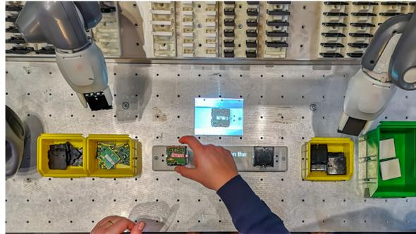
Zusammenbaudarstellungen bieten die Möglichkeit, die Einbauposition und Einbaulage von Bauteilen darzustellen, sodass das reale Bauteil genau über das virtuelle Bauteil gesetzt werden kann.
